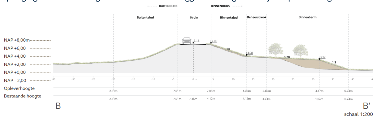
Figuur 3-1: Dwarsprofiel binnenberm vak 34b
