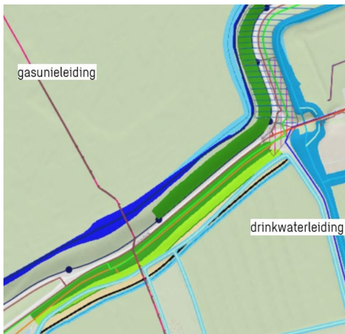
Figuur 3-5: Overzicht van alle kabels en leidingen dijkvak 19a t/m 20
