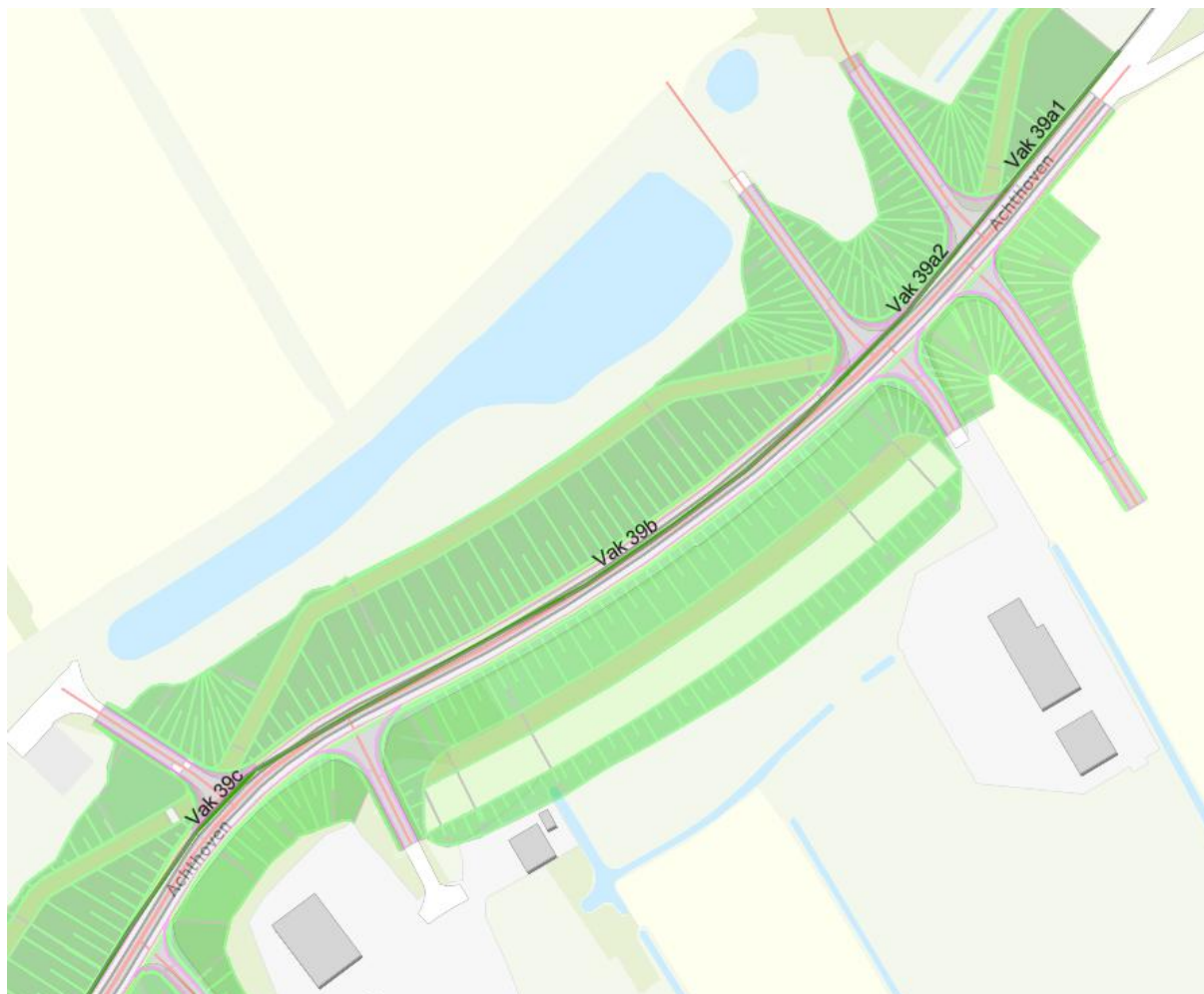
Figuur F2-4: buitendijkse asverschuiving in dijkzone 7 (in donkergroen huidige buitenkruinlijn)
