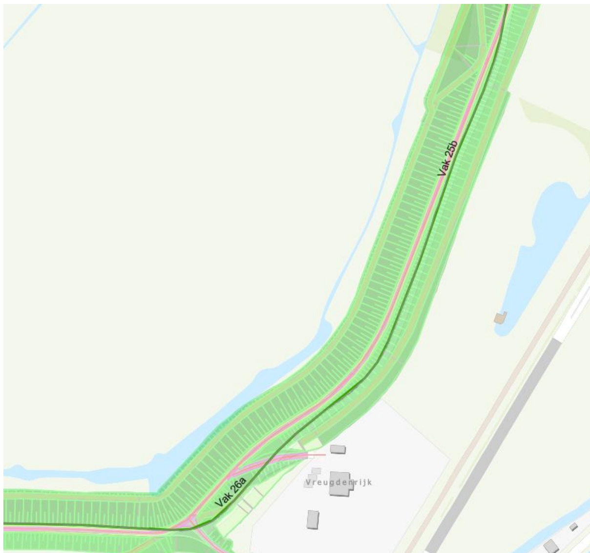
Figuur F2-3: buitendijkse asverschuiving in dijkzone 4 (in donkergroen huidige buitenkruinlijn)
