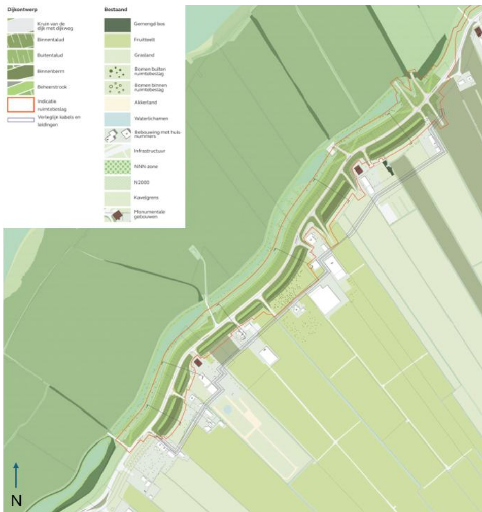
Figuur 2-11: Boven-aanzicht Vergunningen Ontwerp Dijkzone 7.
