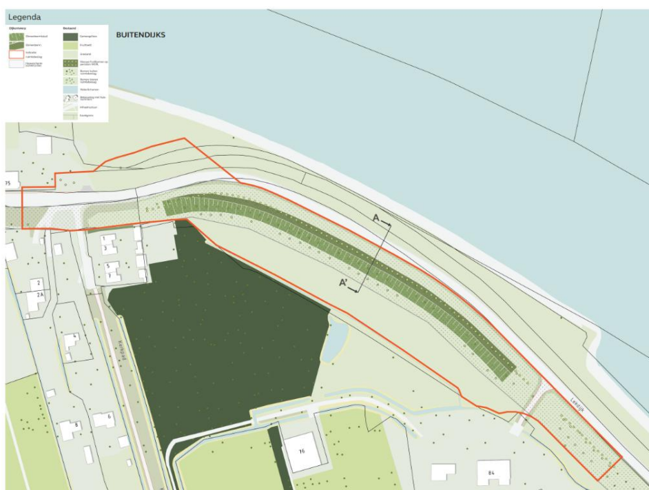
Figuur 2-13: Boven-aanzicht Vergunningen Ontwerp Dijkzone 9.
