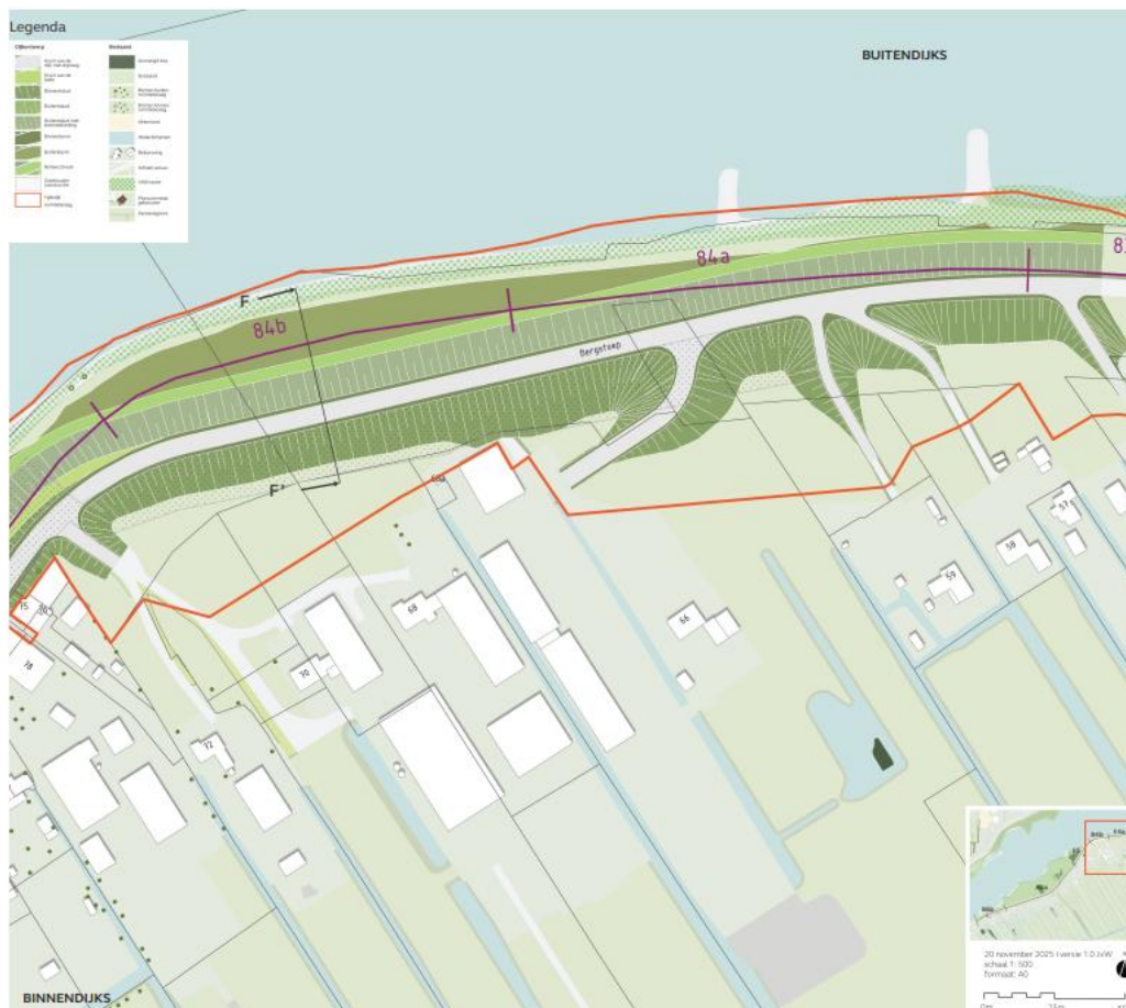
Figuur 2-19: Bovenaanzicht Vergunningen Ontwerp Dijkzone 11 dijkvak 84.
