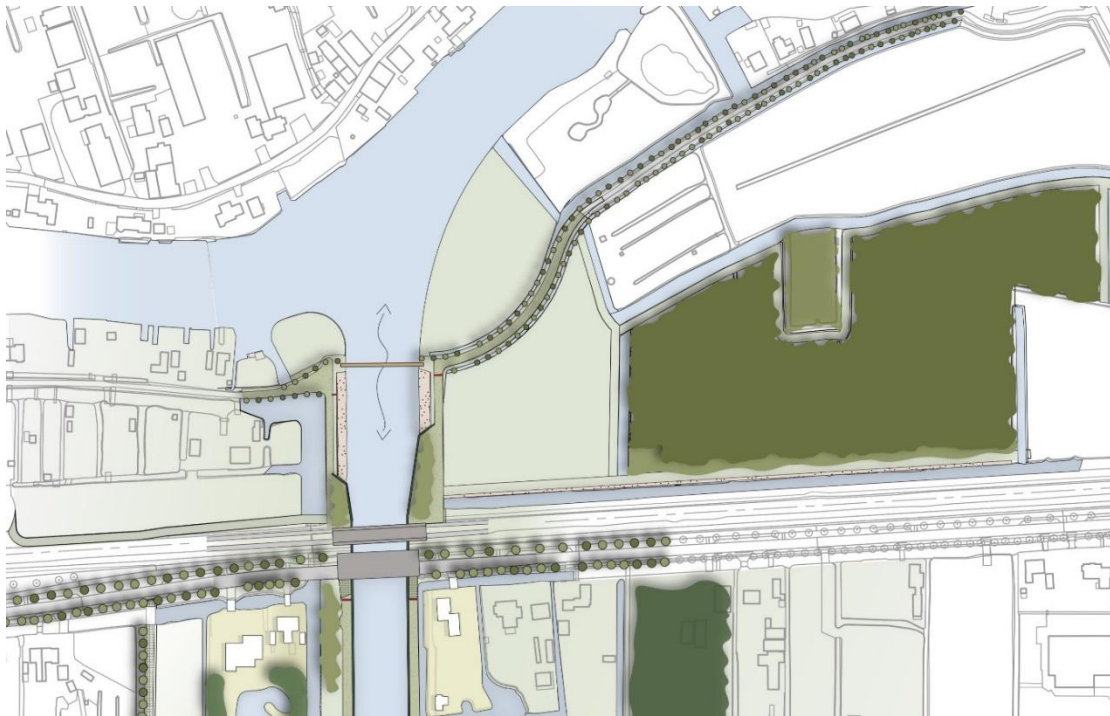
Figuur 4.2 Visualisatie van deelgebied Noord. Vanaf dit punt zal het water vanuit de Giessen het boezemkanaal instromen. Het water stroomt (van boven naar beneden in deze figuur) onder de nieuwe brug van het Pelgrimspad en onder de kruisingen met het spoor en de Parallelweg door. Rechts op de figuur de natuurcompensatie.
