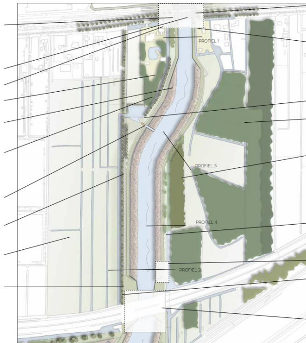
Figuur 4.4 Visualisatie van deelgebied Midden. Boven in de figuur stroomt het water het deelgebied Midden in. Direct rechts naast het boezemkanaal, in het mosgroen, is boscompensatiegebied voor NNN ingetekend. Langs het boezemkanaal zijn de natuurvriendelijke oevers afgebeeld. Tussen het boezemkanaal (links van het boezemkanaal in figuur) en de bomenrij is het zoekgebied voor het nieuwe poldergemaal.
