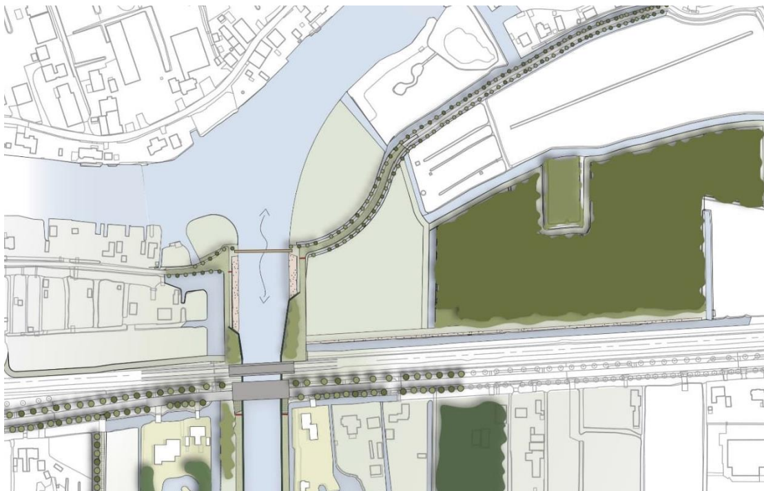
Figuur 5: visualisatie van deelgebied Noord. Vanaf dit punt zal het water vanuit de Giessen het boezemkanaal instromen. Het water stroomt (van boven naar beneden in deze figuur) onder de nieuwe brug van het Pelgrimspad en onder de kruisingen met het spoor en de Parallelweg door. Rechts op de figuur de natuurcompensatie.
