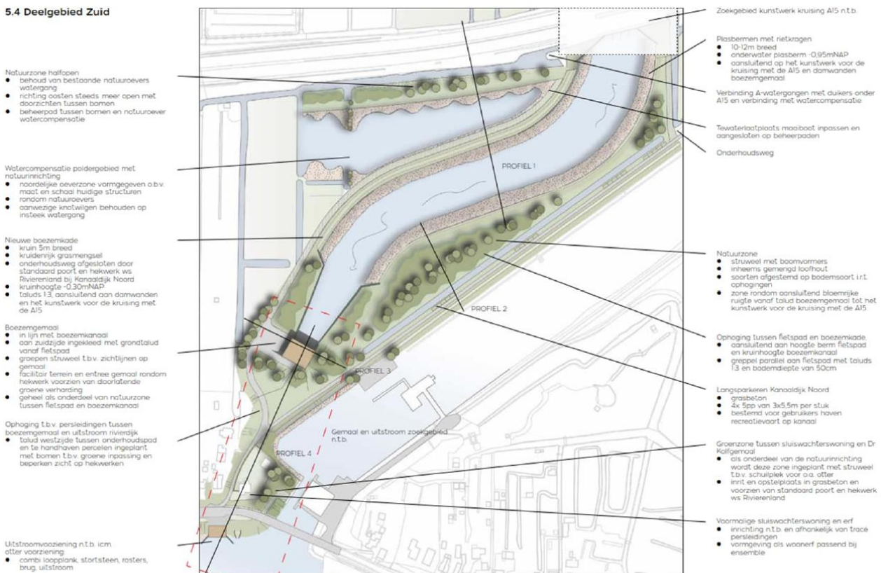
Figuur 7: visualisatie van deelgebied Zuid. Rechtsboven in de figuur is de kruising met de A15 te zien en stroomt het water van het boezemkanaal het deelgebied Zuid in. Boven het kanaal is het watercompensatiegebied ingetekend. Aan het einde van het kanaal bevindt zich het boezemgemaal waar het water de perskokers ingaat en uiterst linksonder via de uitstroombuizing in de Beneden Merwede uitkomt.
