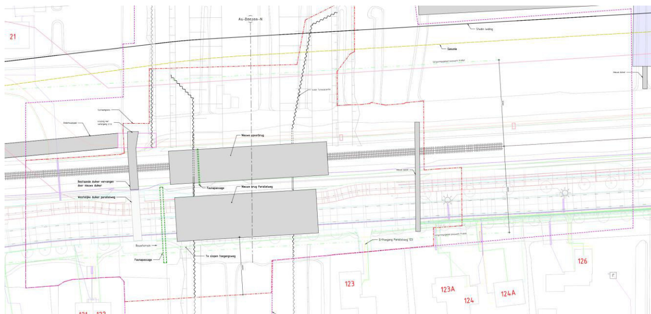
Figuur 3-3: Tekening werkgrens (paars) en systeemgrens (rood)
