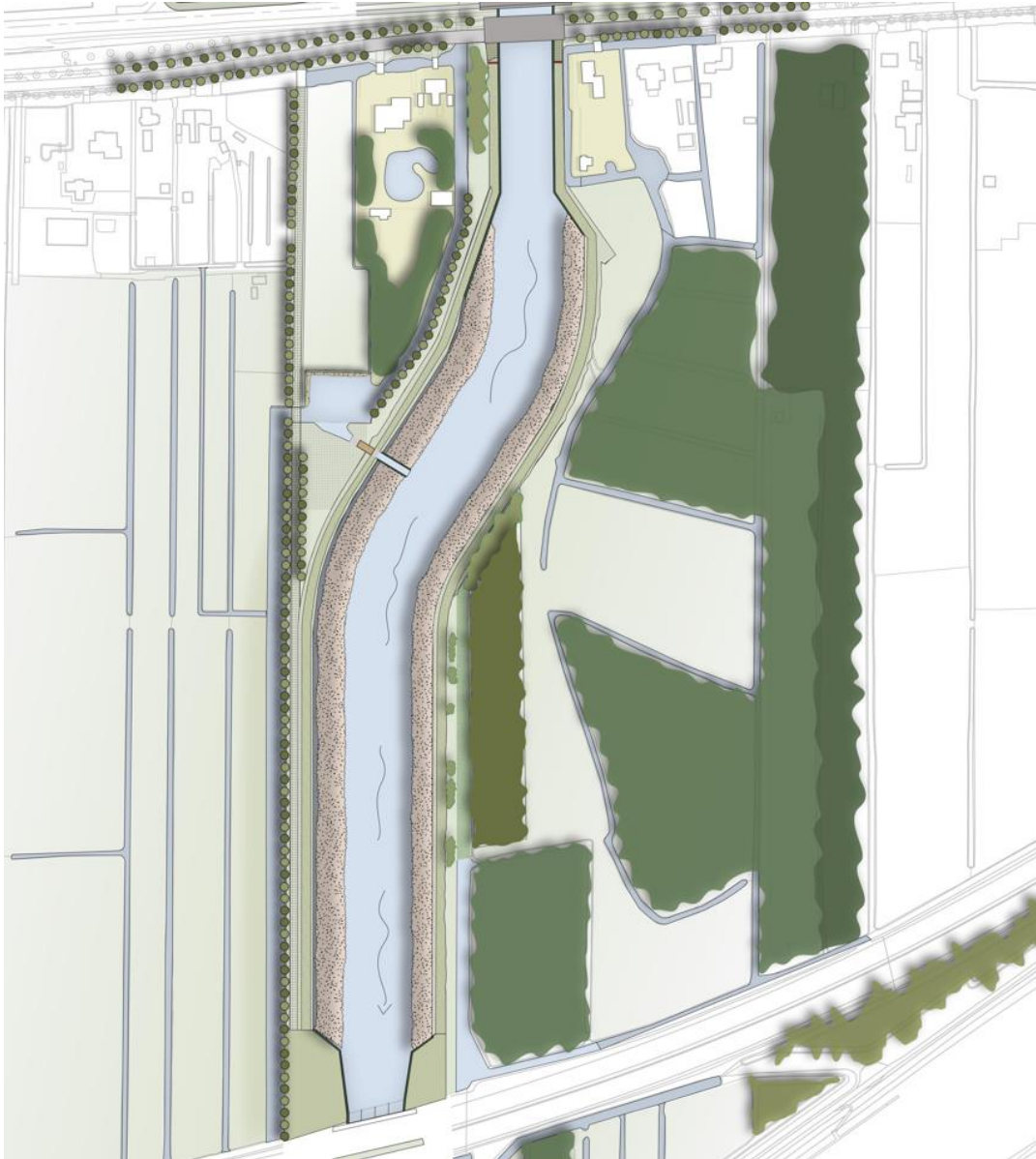
Figuur 1.3 Visualisatie van deelgebied Midden. Boven in de figuur stroomt het water het deelgebied Midden in. Direct rechts naast het boezemkanaal, in het mosgroen, is boscompensatiegebied voor NNN ingetekend. Langs het boezemkanaal zijn de natuurvriendelijke oevers afgebeeld. Tussen het boezemkanaal (links van het boezemkanaal in figuur) en de bomenrij is het zoekgebied voor het nieuwe poldergemaal.
