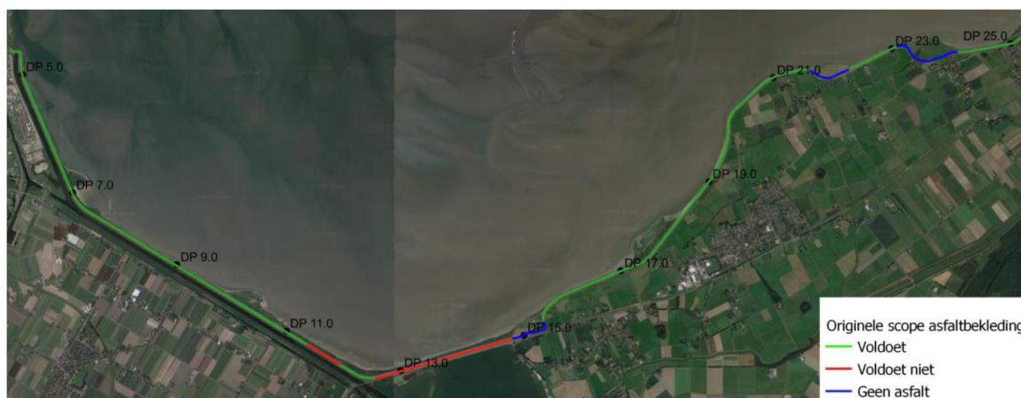
Afbeelding 7.6 Originele scope onderrand asfaltbekleding (start verkenningfase)
