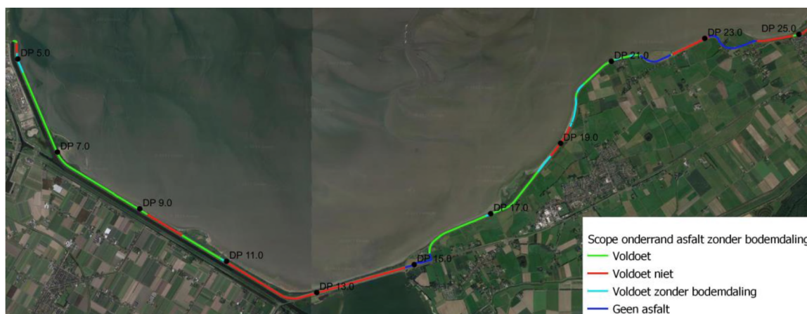
Afbeelding 7.8 Scope onderrand asfaltbekleding zonder bodemdaling na aanpassingen aan freatische lijn
