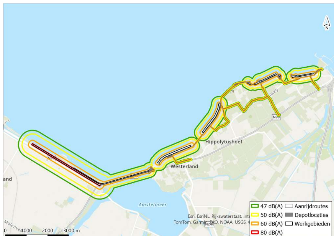
Afbeelding 3.1 Weergave contourafstanden tot geluidsniveaus van 47, 50, 60 en 80 dB(A)
