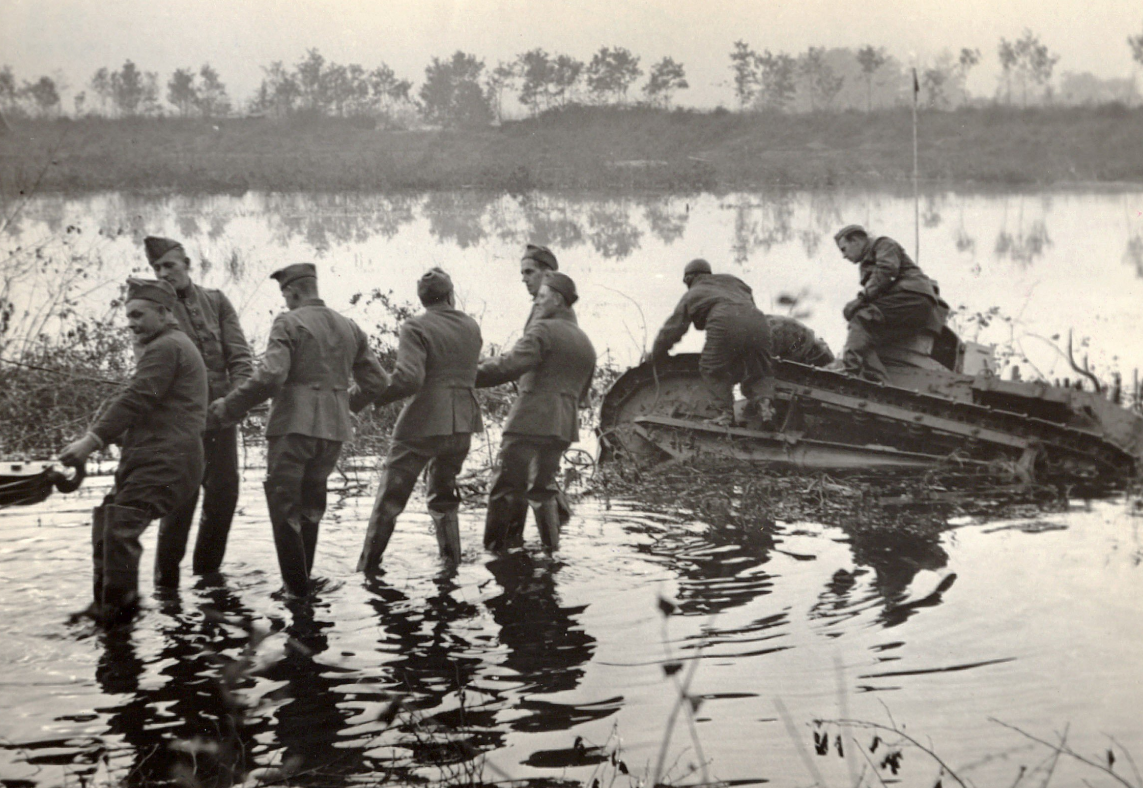
Foto uit 1939 van een proefneming in het doorschrijden van geïnundeerd gebied met een lichte tank van het type Renault 'FT 17'. Bron: Nederlands Instituut voor Militaire Historie.
