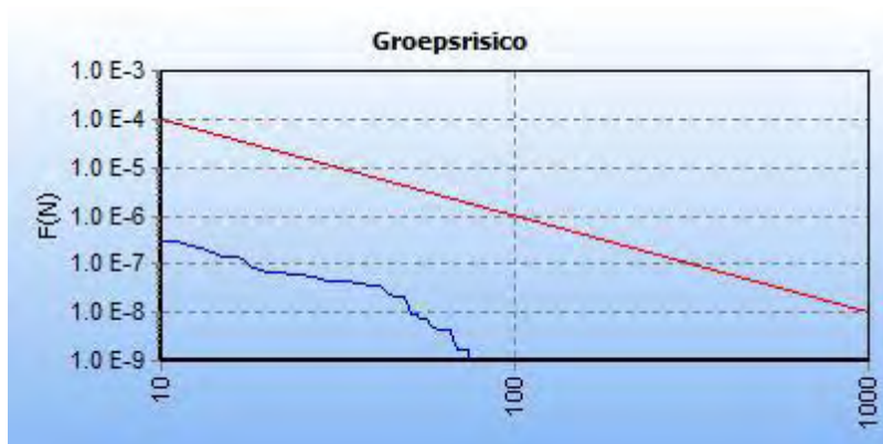
Figuur 5.3 FN curve W-571-03 van N.V. Nederlandse Gasunie voor de kilometer tussen stationing 2770.00 en stationing 3770.00
