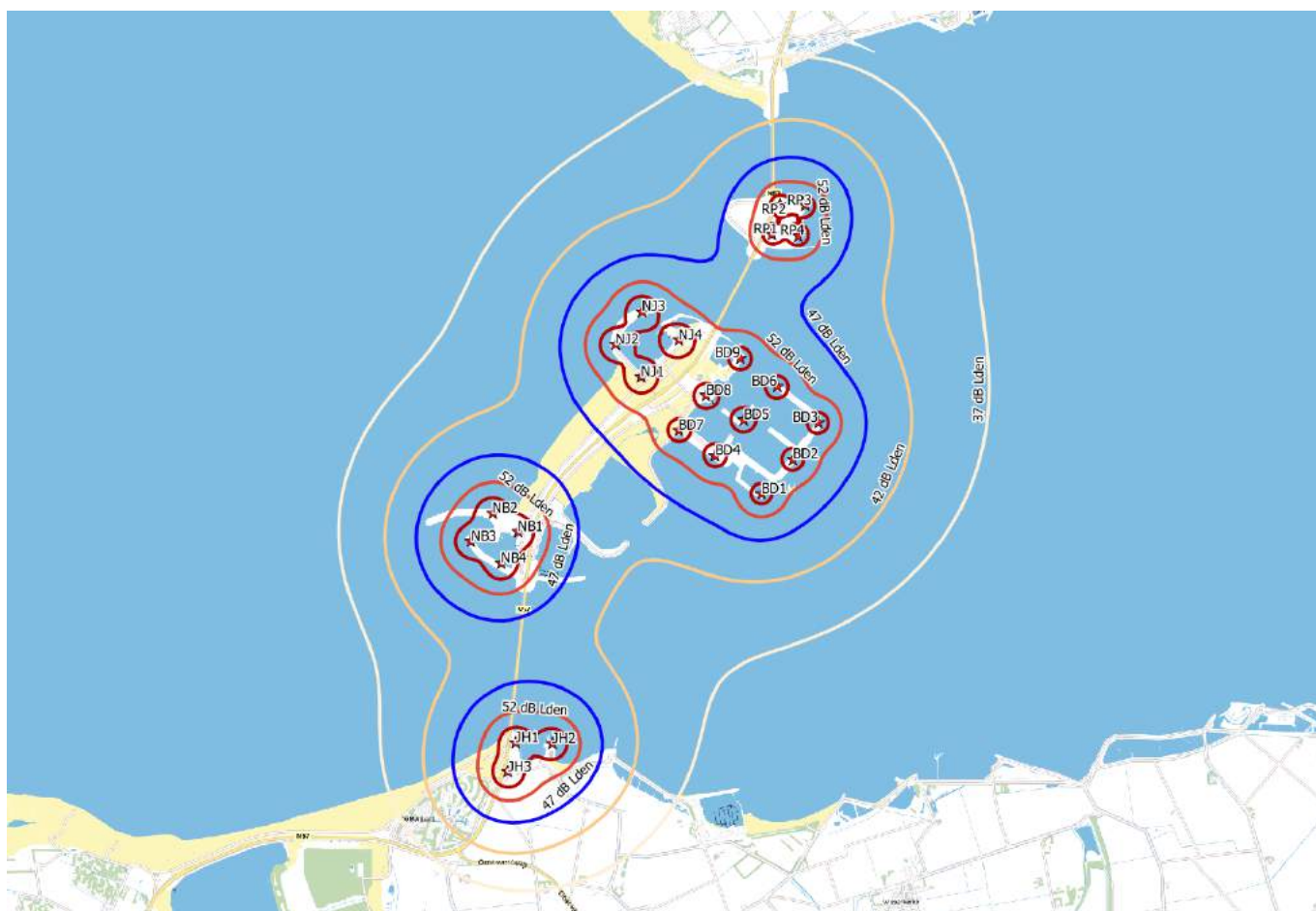
Figuur 10.1 Ligging maatgevende geluidscontouren ( L_{den} 47 dB) van de bestaande windturbines in de huidige situatie
