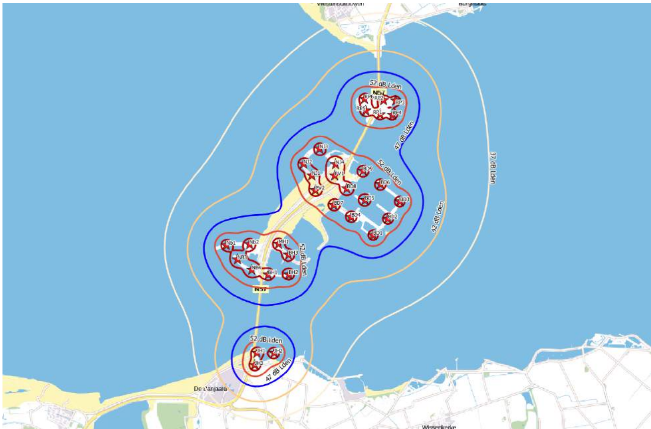
Figuur 6.7 Ligging maatgevende geluidscontouren ( L_{den} 47 dB) van de nieuwe windturbines in het VKA in de tijdelijke situatie (2020-2028)
