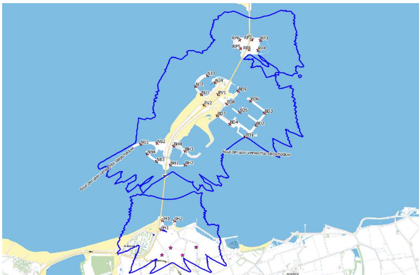
Figuur 11.4 Ligging contour waarbinnen mogelijk meer dan 6 uur per jaar slagschaduwinder kan optreden bij alternatief 3B (2028) (worst case)
