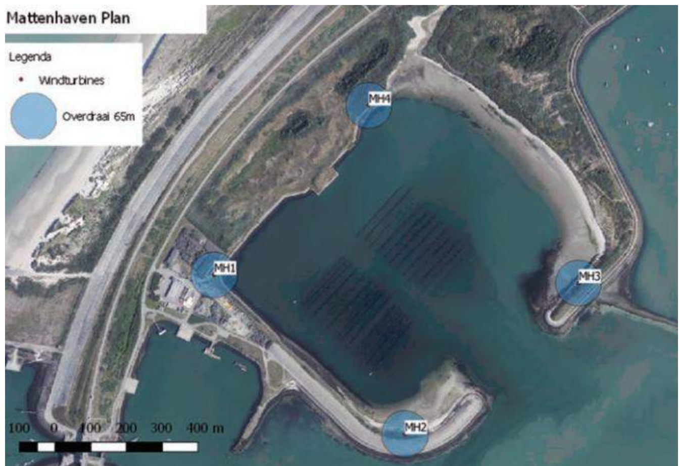
Figuur 2.13 Lay-out met de te onderzoeken windturbineposities in het Alternatief Mattenhaven
