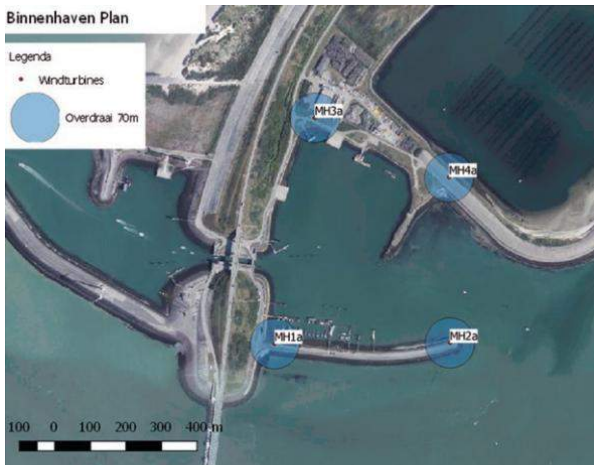
Figuur 2.14 Lay-out met de te onderzoeken windturbineposities in het Alternatief Binnenhaven
