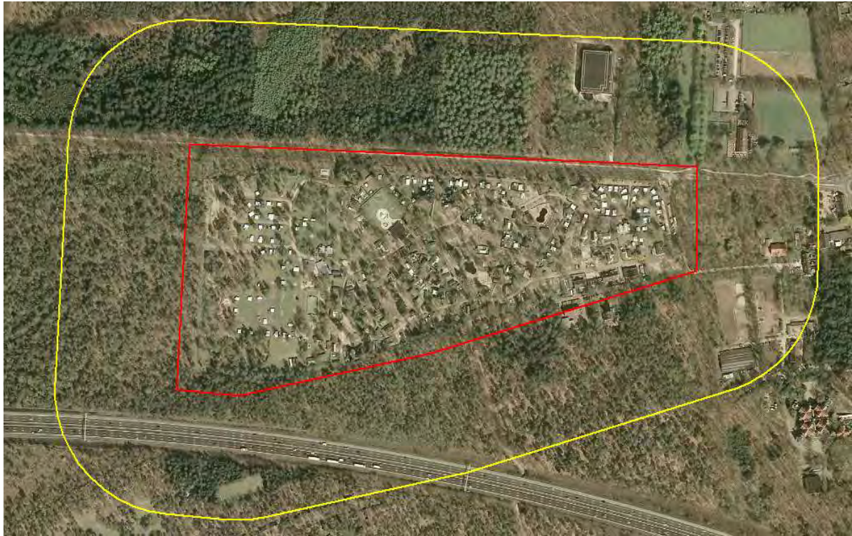
Figuur 1. Begrenzing van het werkgebied (rood) en het onderzoeksgebied (geel). Ten behoeve van de analyse is voor de begrenzing van het onderzoeksgebied de in de WSCS-OCE maximale genoemde afstand (181m) voor de afbakening van verdacht gebied bij (duik)bombardementen gehanteerd.
