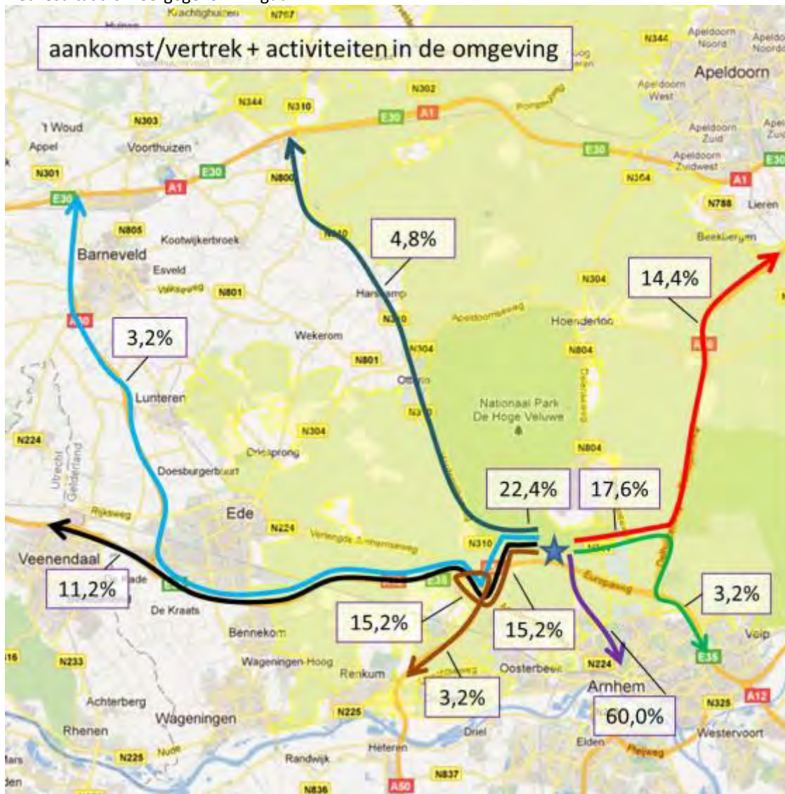
Figuur B2.1 Verdeling verkeer als gevolg van aankomst/vertrek en activiteiten vanaf DroomPark Hoge Veluwe
