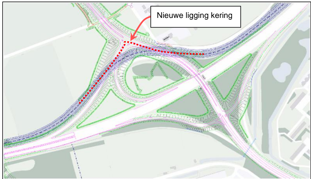
Figuur 4.11: Nieuwe ligging van de compartimenteringskering van waterschap Aa en Maas, in rood gestippeld. De vorm volgt de ligging van de weg.
