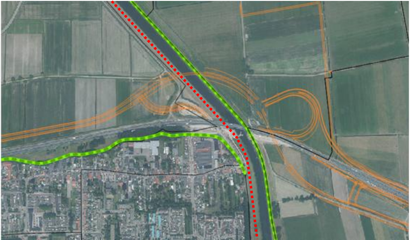
Figuur 6.8: Waterkeringen voor GOL West. Groen gestippeld de regionale keringen van de waterschappen. Rood gestippeld de regionale waterkering van Rijkswaterstaat.
