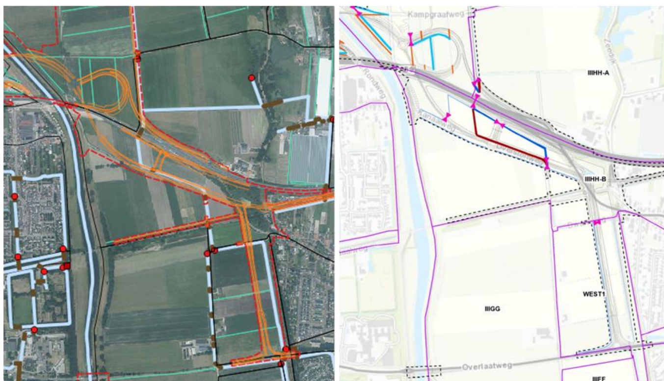
Figuur 6.2: Watersysteem GOL West: deel Aa en Maas. Rechts de aanpassingen. In donkerblauw de nieuw te graven A-watergang, in donkerrood de te dempen A-watergang. Lichtblauw de te graven B-watergangen en oranje de te dempen B-watergangen. Duikers verbinden de watergangen met elkaar wanneer wegen worden gekruist. In bijlage IV is een kaart opgenomen met te graven en dempen watergangen.
