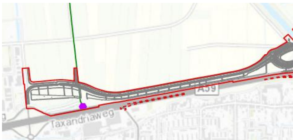
Figuur 6.5: Rioolpersgemaal (paars) en persriool (groene lijn) ten noorden van Waalwijk
