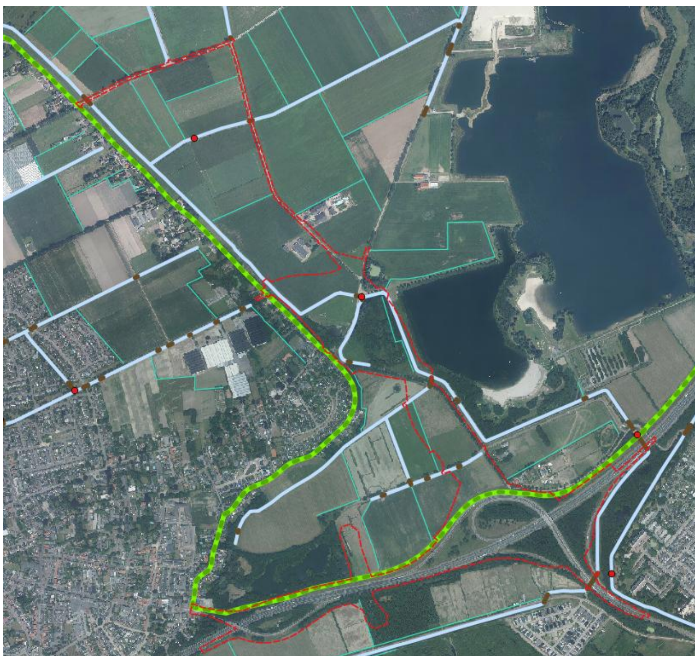
Figuur 4.10: Waterkeringen voor GOL Oost. Groen gestippeld de huidige regionale kering (compartimenteringskering) van waterschap Aa en Maas.
