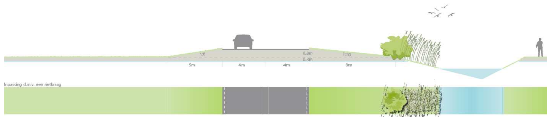
Afbeelding 6.19: indicatie profiel met ecologische zone
