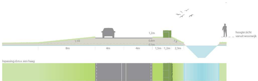
Afbeelding 6.7: indicatie profiel rondweg met haag
