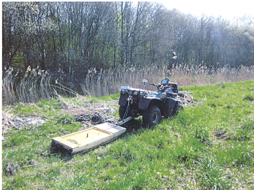
Figuur 2: quad met grondradar op de onderzoekslocatie.
