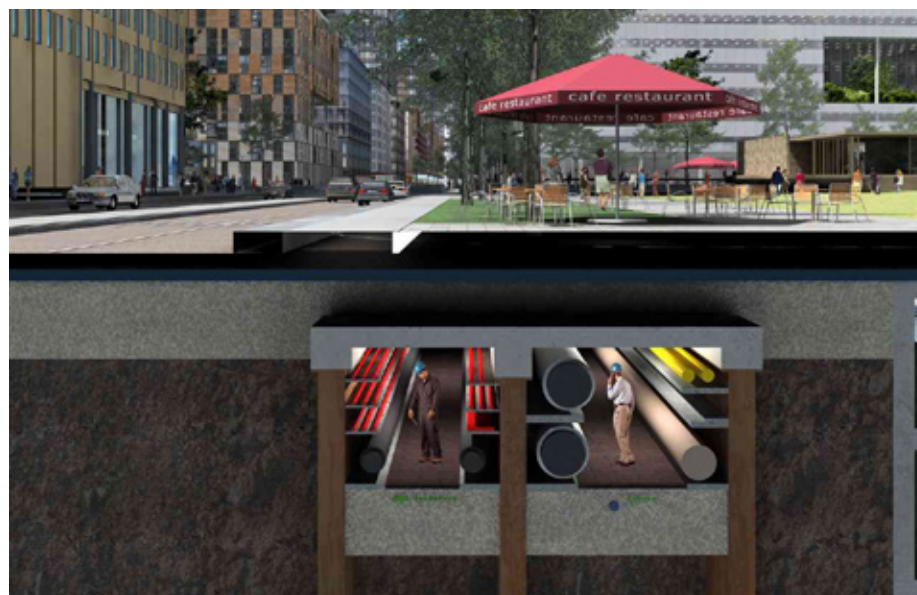
▲ ILT: integrale leidingtunnel
