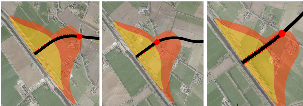
Figuur 4.3: Aansluiting zuidelijke ontsluitingsweg op de verbrede N279 (van rechts naar links: variant N279 Noord, variant N279 midden en variant N279 zuid).
