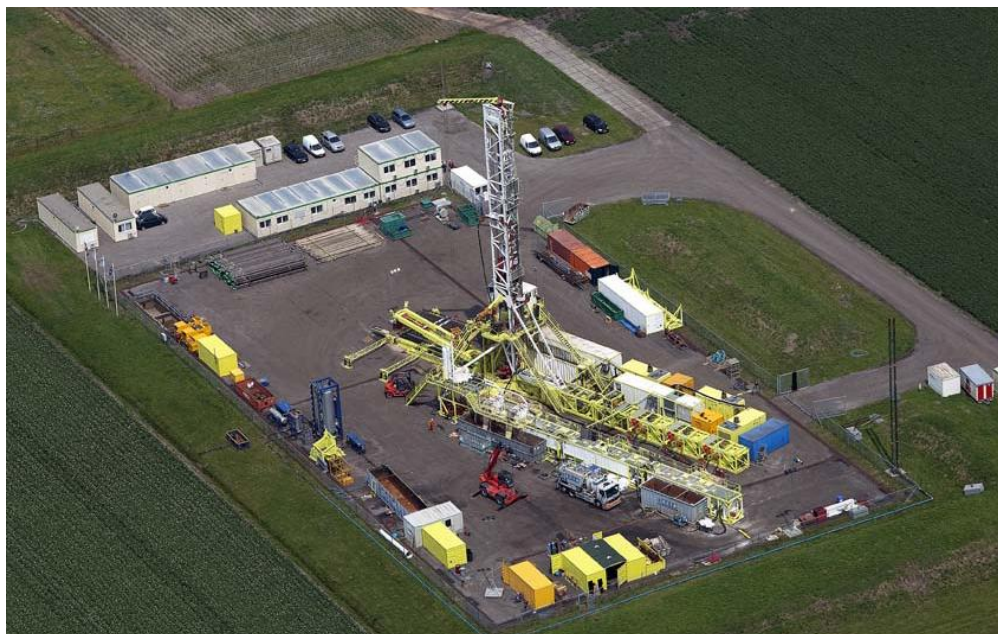
Figuur 6.2 Voorbeeld indeling boorlocatie (bron: NDDC)
