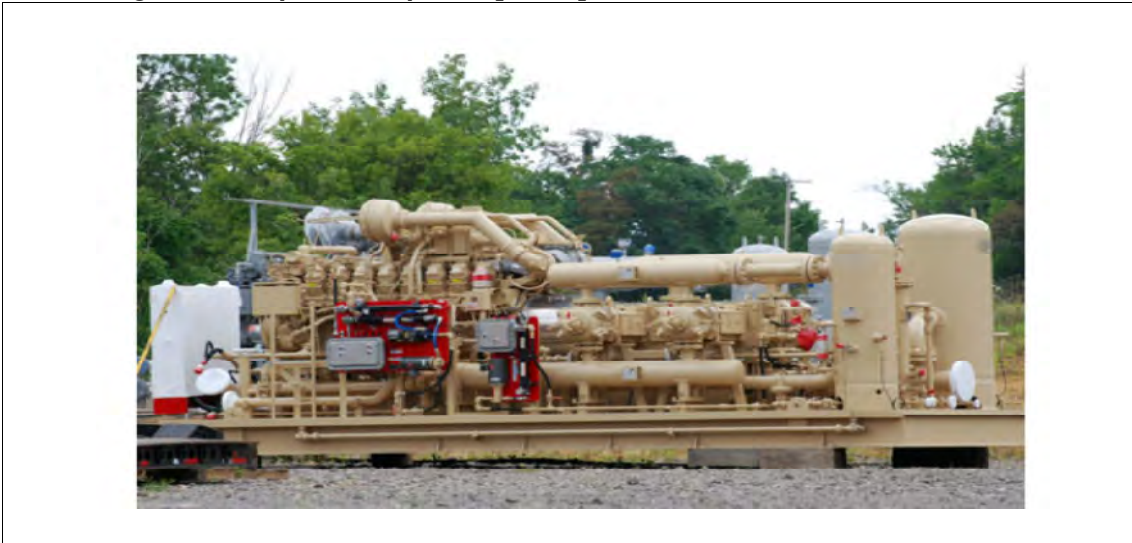
Afbeelding 2.9. Compressor op skid [ref. 2.]
