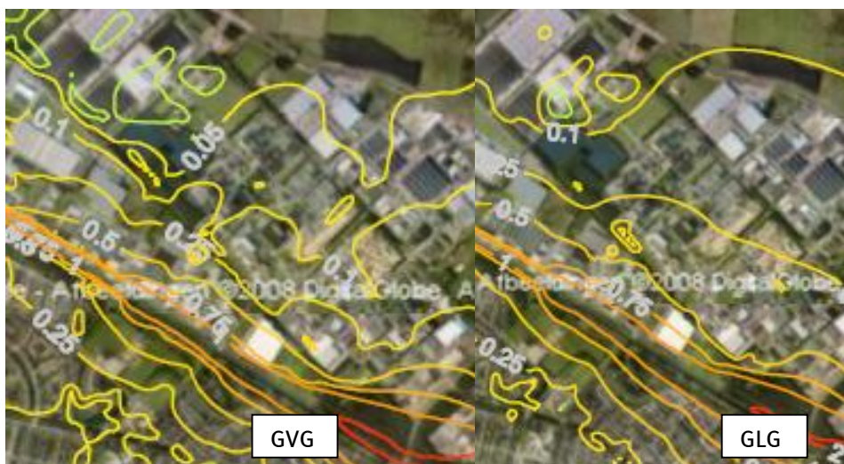
Figuur 1.14: Verlaging van de grondwaterstand in deelterrein Vossenberghoek bij GVG en GLG.
