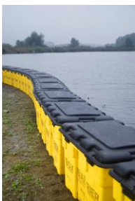
Figuur 5.2.5 BoxBarrier Kenmerken BoxBarrier50: kerende hoogte van 0,5m, installatie van 100m binnen 1 uur (team van 3 man), compacte vorm (LxBxH=0,9x0,6x0,6m). Grotere BoxBarriers zijn in ontwikkeling.
