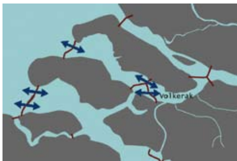
FIGUUR 24 Meer invloed van de zee. Alleen de dammen aan de zeezijde openen, waardoor zout en getij weer tot het gebied door kunnen dringen. Het Volkerak wordt daarmee een onderdeel van het Oosterscheldebekken en/of de Grevelingen. Wenselijk, en op korte termijn deels mogelijk.
