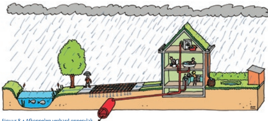
Figuur 8.4 Afkoppelen verhard oppervlak
