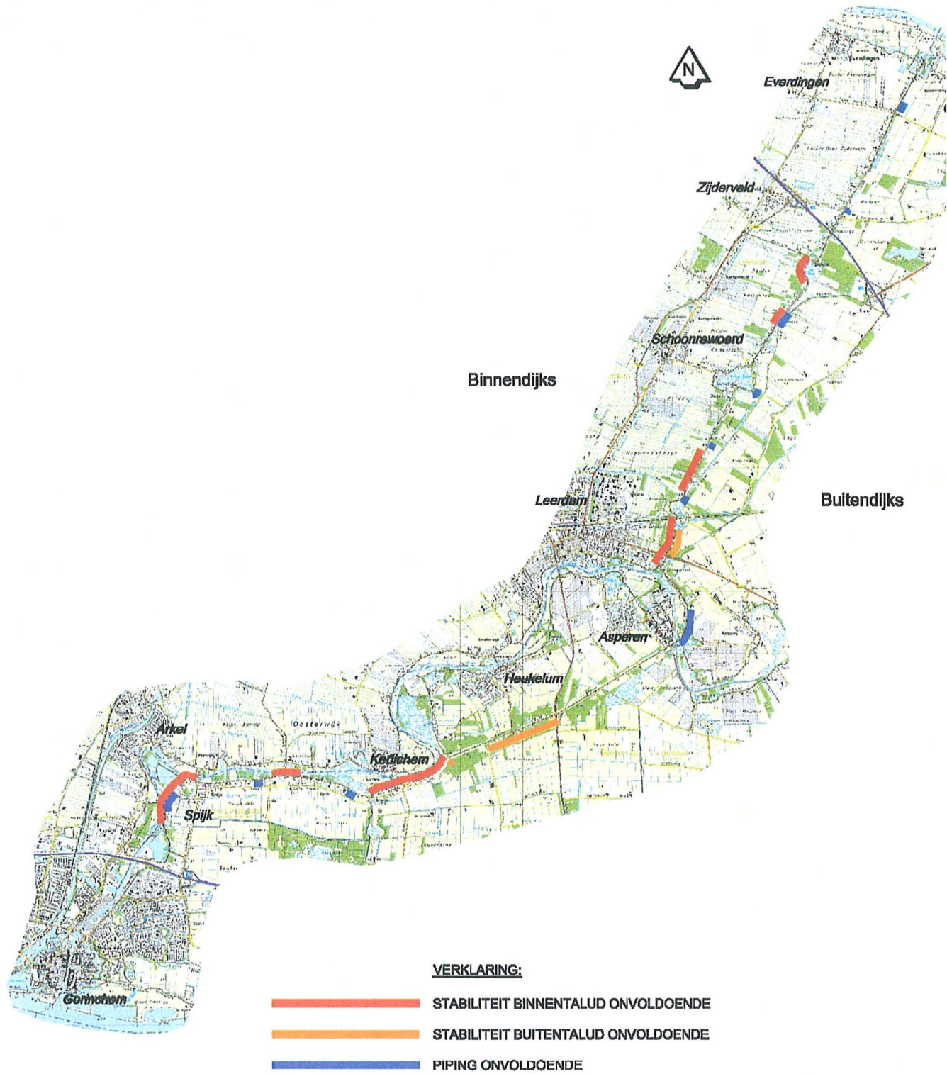
Figuur 2-1 Situering zwakke plekken op basis van de resultaten van de toetsing op macrostabiliteit binnen- en buitenwaarts, opbarsten/piping
