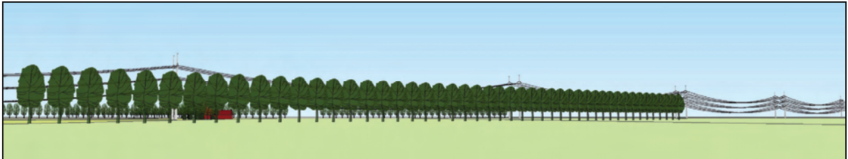
Figuur 16.1 Fictieve situatie waarbij de afstand van de waarnemer tot de lijn circa 750 m is (in het centrum van het beeld) en de afstand van de laanbeplanting, met een hoogte van circa 25 m, tot de waarnemer circa 550 m. De lijn is boven de bomen zichtbaar.
