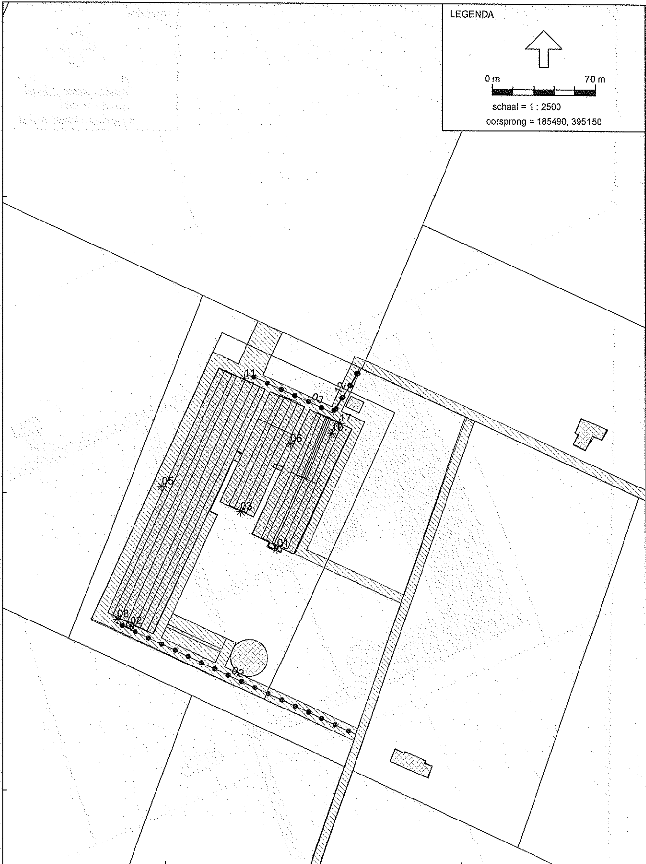
Industrielawaai - iL, Bjaarpeelweg ong. te De Rips - Inrichting VOF Relou - Gloudemans - Aangevraagde situatie scenario 1 [N:\Lokale projecten geonoise v5.1\26700ao0207], Geonoise V5.4 Figuur 1.4.3: geluidbronnen afvoer spuiwater/ zwavelzuur, stationaire bronnen, varkens laden/lossen
