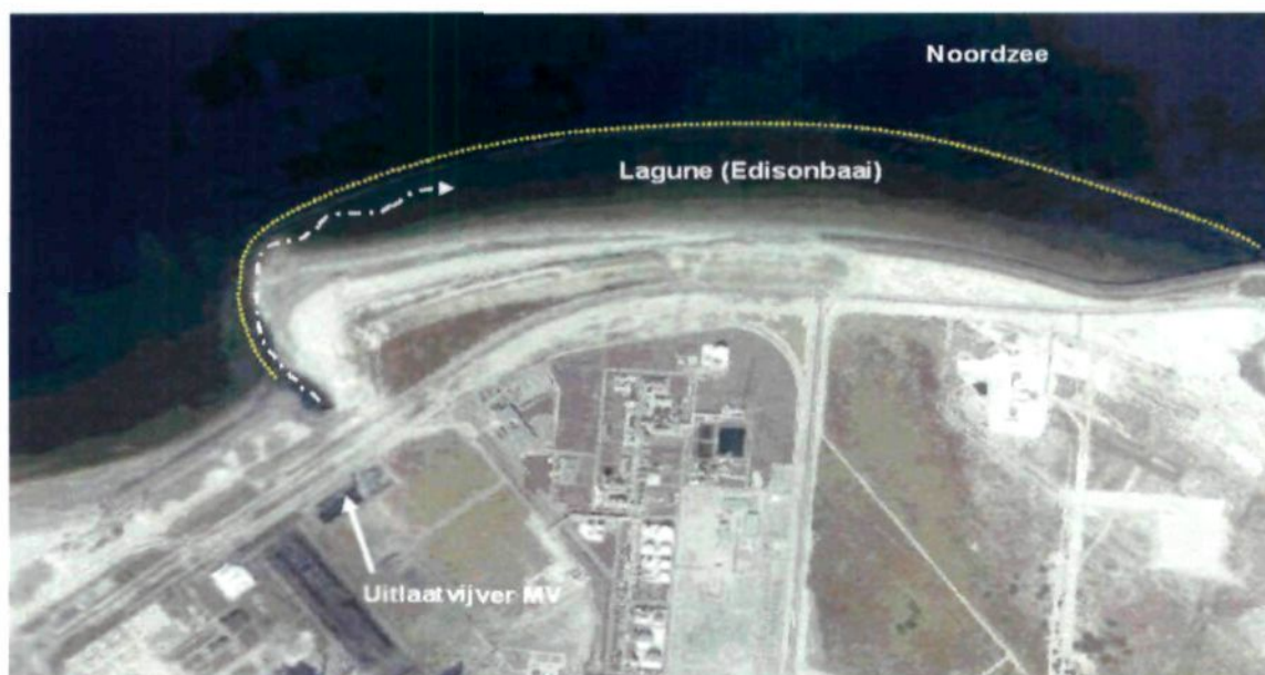
Figuur 2 Uitlaatgebied van de centrale Maasvlakte met de uitlaatvijver en de lagune. De witte stippellijn geeft de route van het koelwater weer, de gele stippellijn arceert de blokkendam die de lagune afsluit van de Noordzee (bron: Google-earth)
