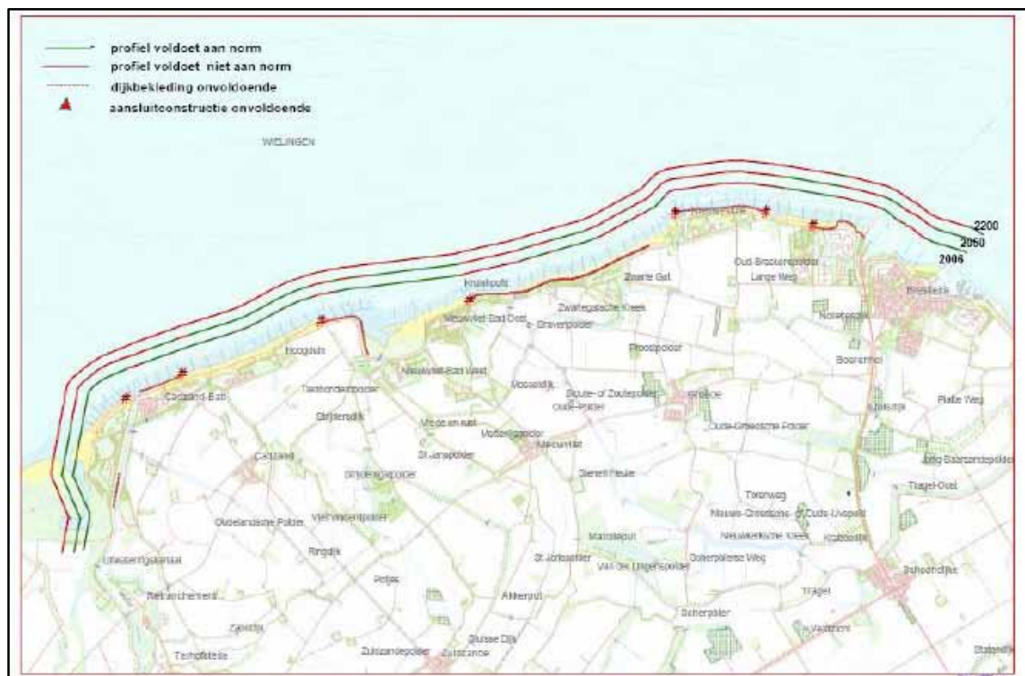
Figuur 2-1: Kwetsbare delen van de kust als gevolg van zeespiegelstijging en grotere golfaanval in West Zeeuwsch-Vlaanderen tot het jaar 2200 (Bron: Startnotitie Zwakke Schakel West Zeeuwsch-Vlaanderen en project Waterdunen).
