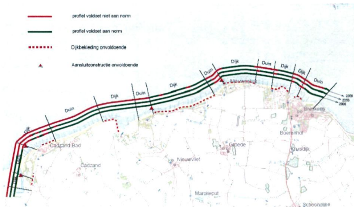
Figuur 2-2: de verwachte ontwikkeling van kustveiligheid onder invloed van zeespiegelstijging in West Zeuwsch-Vlaanderen tot het jaar 2200
