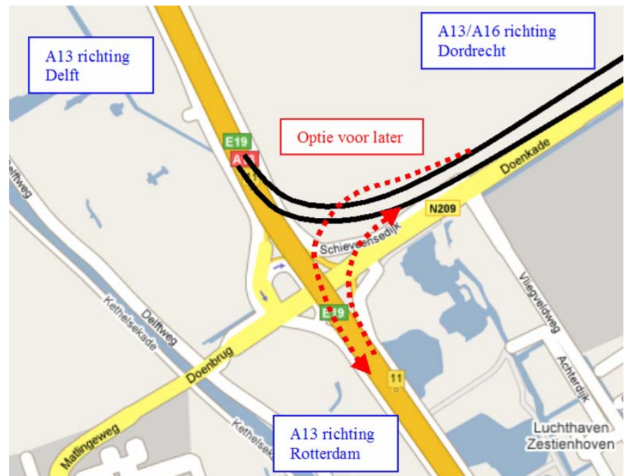
Figuur 5.13.1: Verbindingsbogen aansluitingen Rijksweg A13
