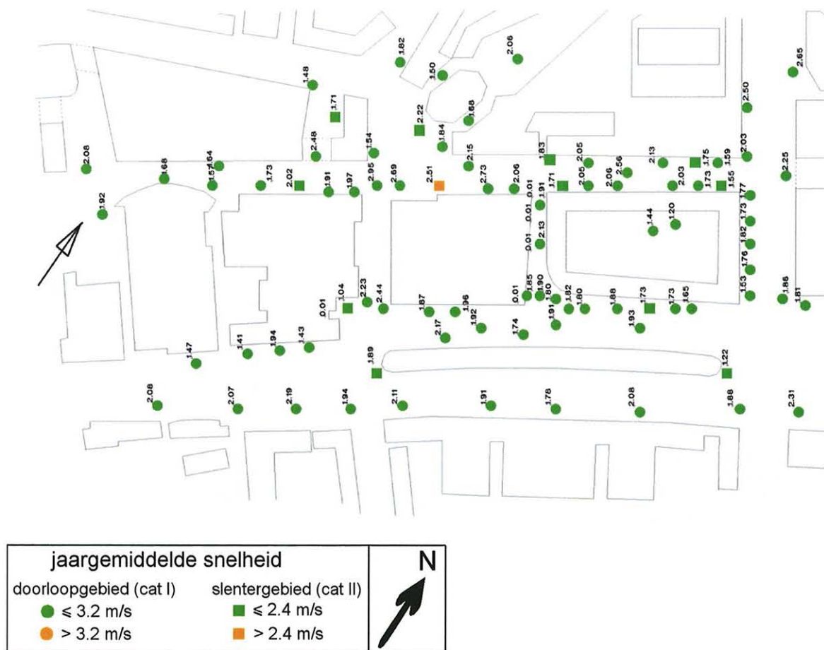
Figuur 8. Resultaten windhinder voor het renovatie alternatief
