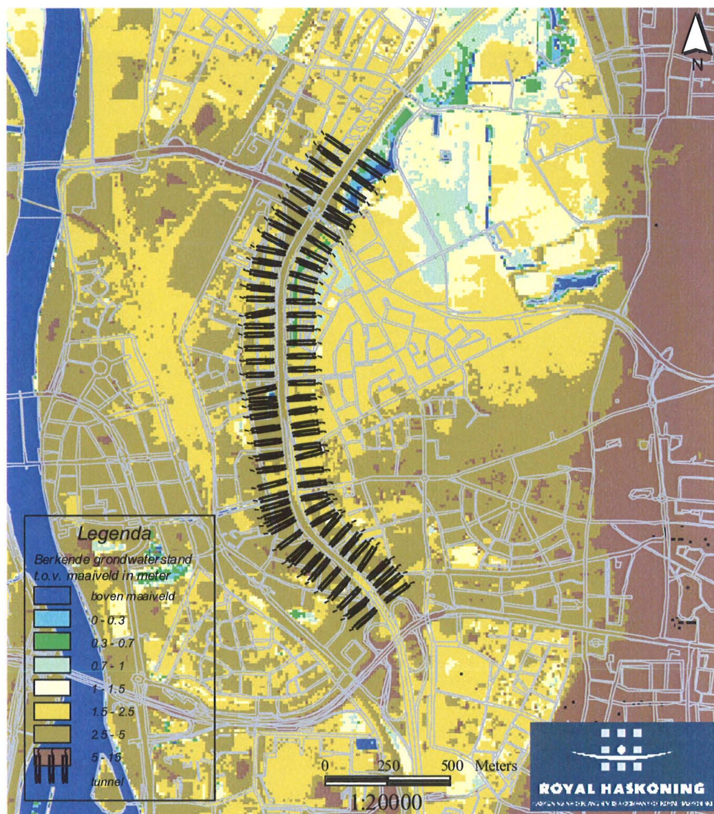
Figuur 9 Grondwaterstanden (m-maaiveld) met een overschrijdingsfrequentie van 1/100 jaar, voor aanleg van de tunneltraverse, na sluiting van de pompstations De Tombe en Borgharen
