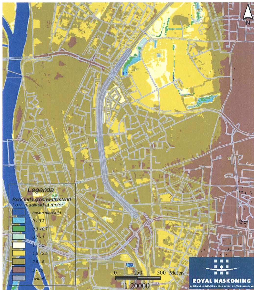
Figuur 10 Gemiddeld hoogste grondwaterstand (GHG, in m t.o.v. maaiveld) na aanleg van de tunneltraverse, na sluiting van de pompstations De Tombe en Borgharen
