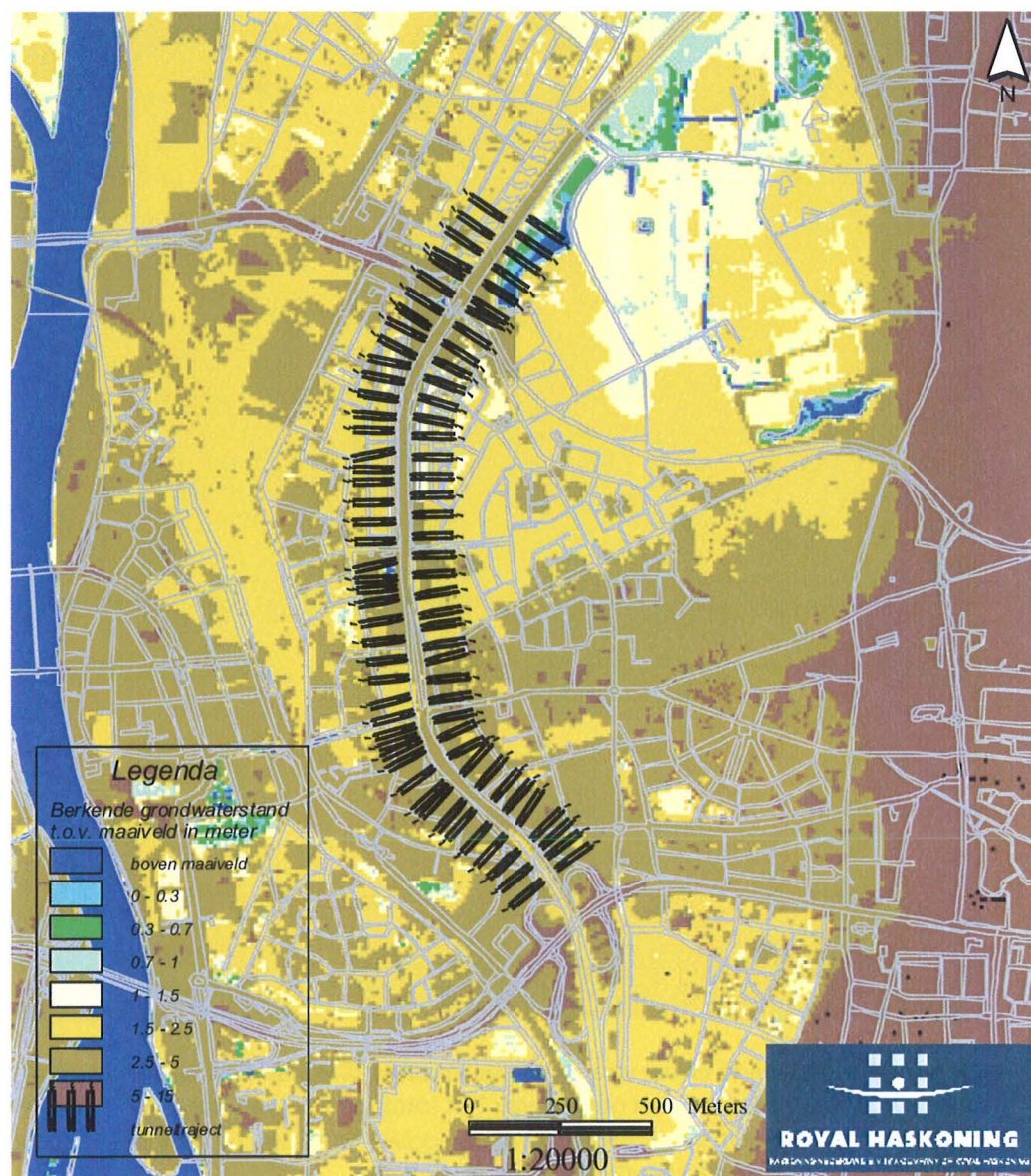
Figuur 7 Gemiddeld hoogste grondwaterstand (GHG, in m t.o.v. maaiveld) voor aanleg van de tunneltraverse, na sluiting van de pompstations De Tombe en Borgharen
