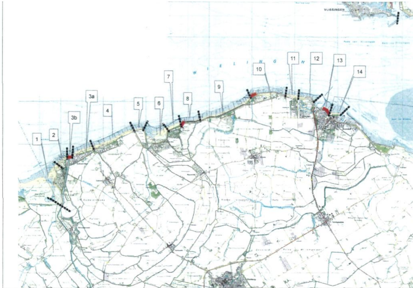
Figuur 1. Overzichtkaart van West Zeeuwsch-Vlaanderen. De scheiding van de verschillende dijktrajecten is met een zwarte stippellijn aangegeven. De dijktrajecten zijn genummerd. Tevens zijn de prioritaire gebieden met rood aangegeven.
