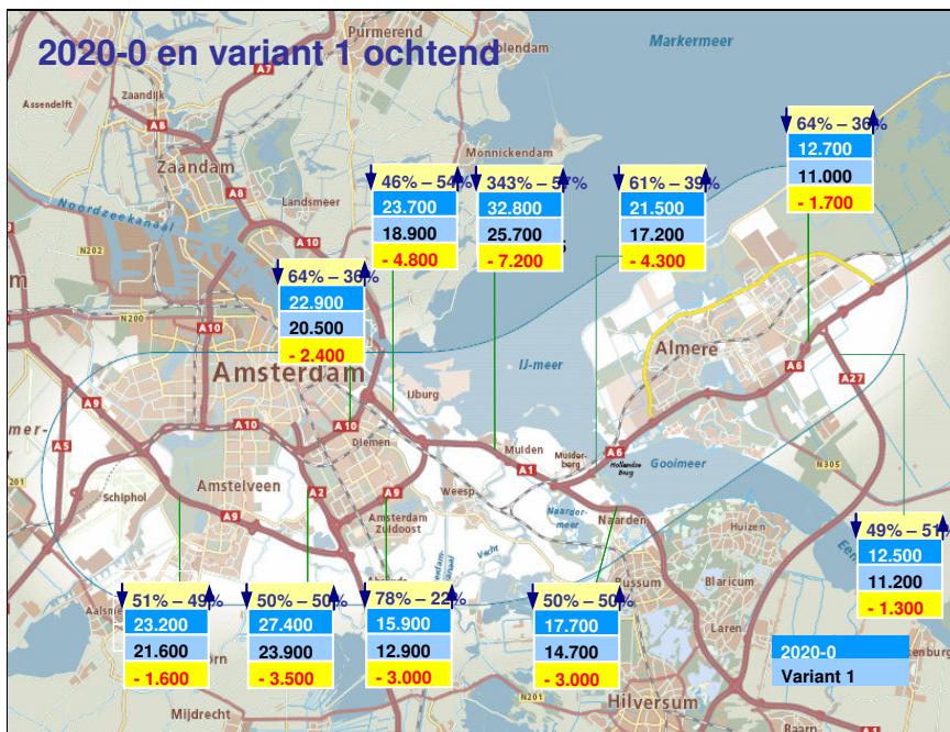
Figuur 4.3: Intensiteiten Nulplusvarianten 2020-0+ var.1 en var.2, ochtend- en etmaal (doorsnede)
