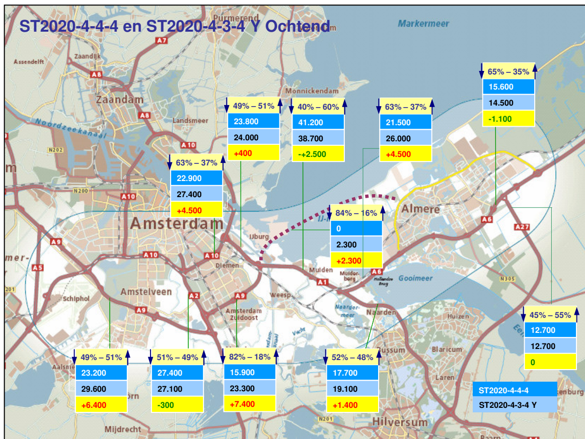
Figuur 7.2: Intensiteiten ST2020-4-4-4 en ST2020-4-3-4Y etmaal en ochtendspits (doorsnede)
