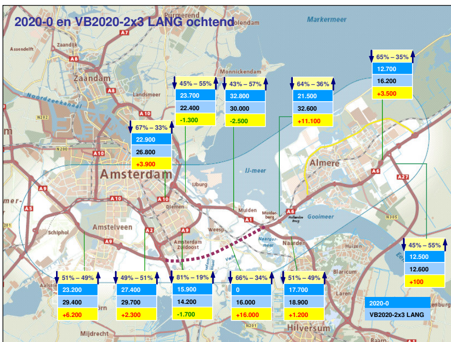
Figuur 5.13: Intensiteiten 2020-0 en VB2020-2x3 en VB2020-2x3 Lang etmaal en ochtendspits (doorsnede)
