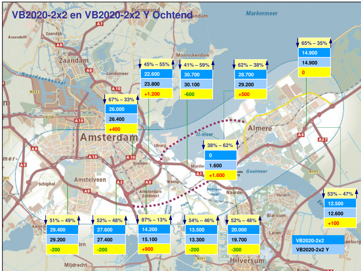
Figuur 7.3: Intensiteiten VB2020-2x2 en VB2020-2x2 Y etmaal en ochtendspits (doorsnede)
