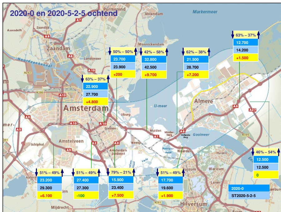
Figuur 5.2: Intensiteiten 2020-0 en ST2020-5-2-5 en ST2020-4-4-4 etmaal en ochtendspits (doorsnede)
