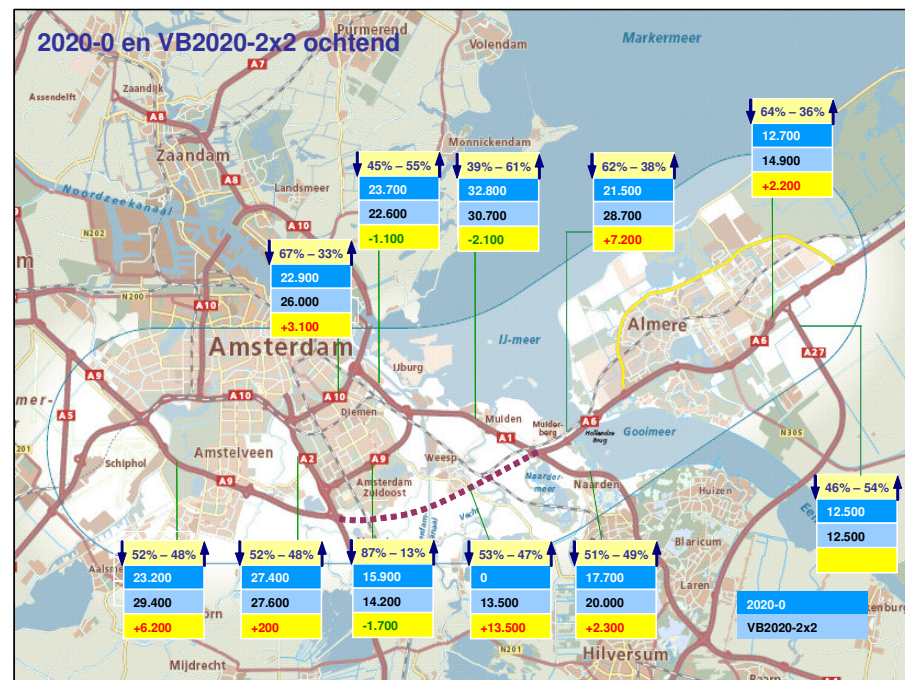
Figuur 5.8: Intensiteiten 2020-0 en VB2020-2x3 en VB2020-2x2 etmaal en ochtendspits (doorsnede)
