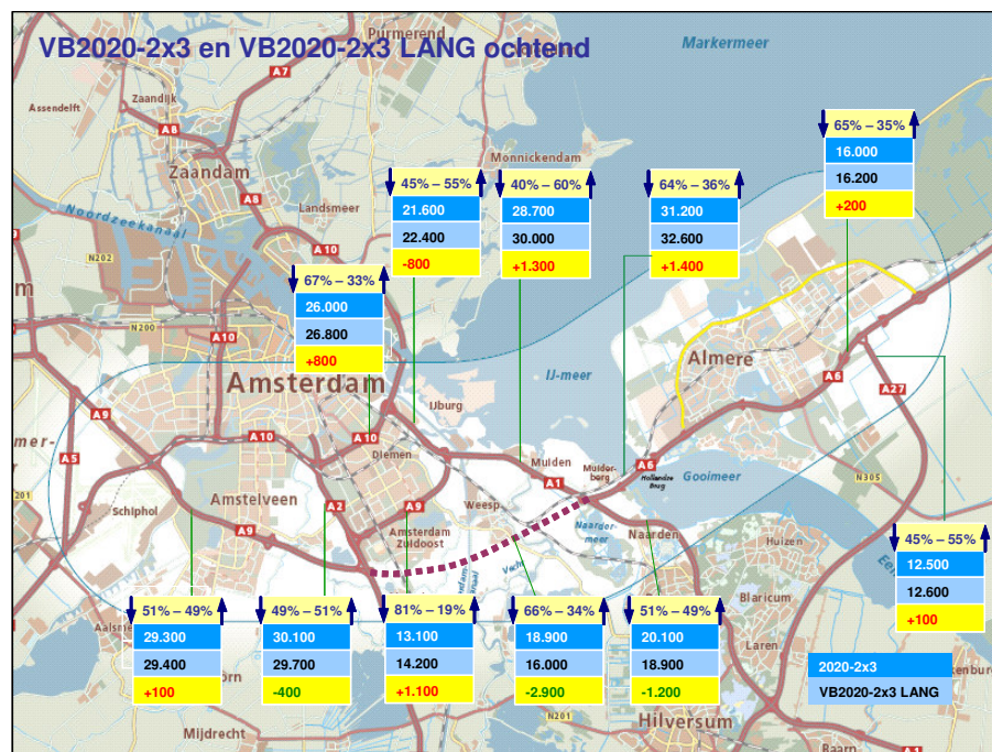
Figuur 5.13: Intensiteiten 2020-0 en VB2020-2x3 en VB2020-2x3 Lang etmaal en ochtendspits (doorsnede)
