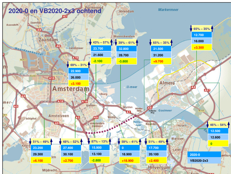
Figuur 5.8: Intensiteiten 2020-0 en VB2020-2x3 en VB2020-2x2 etmaal en ochtendspits (doorsnede)
