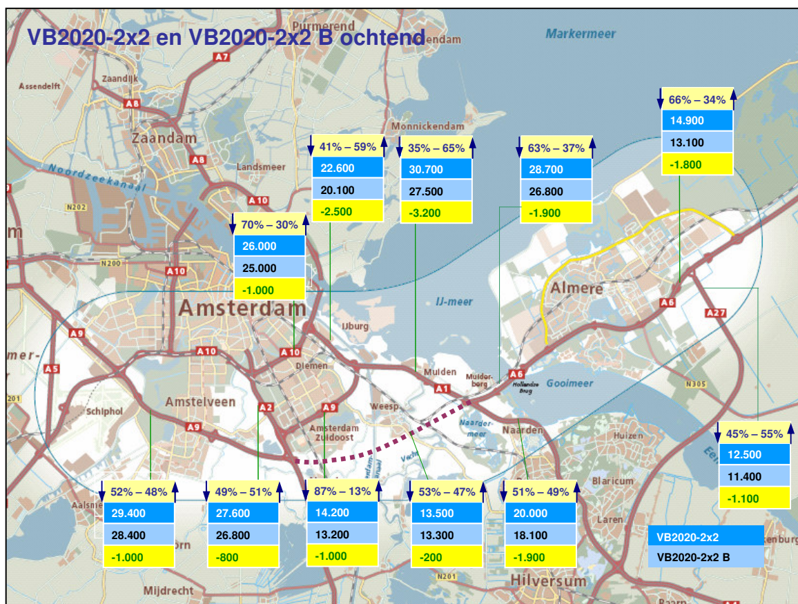
Figuur 7.12: Intensiteiten VB2020-2x2 en VB2020-2x2 B etmaal en ochtendspits (doorsnede)
