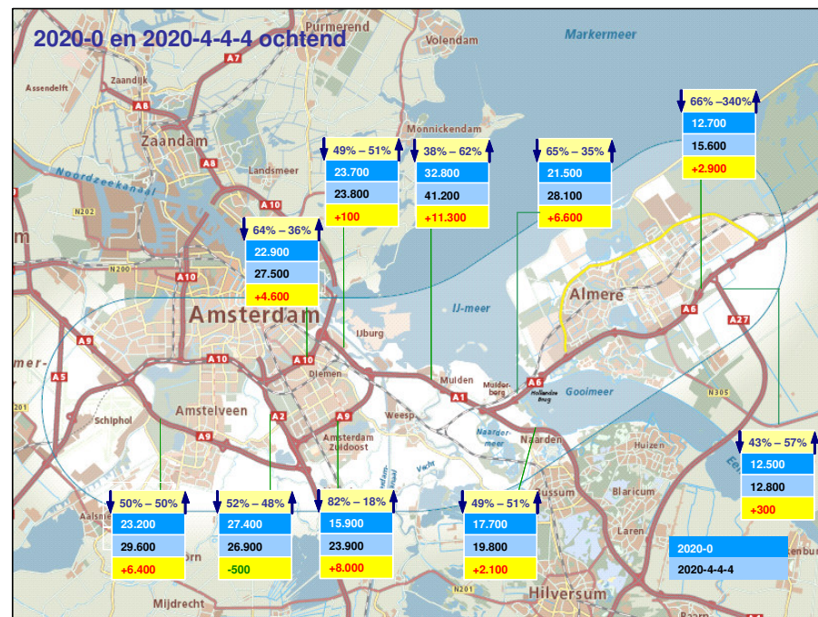
Figuur 5.2: Intensiteiten 2020-0 en ST2020-5-2-5 en ST2020-4-4-4 etmaal en ochtendspits (doorsnede)
