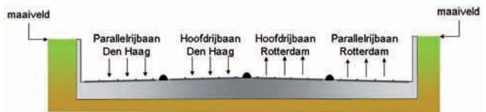
Figuur 4.10 Schematisch dwarsprofiel verdiepte ligging
