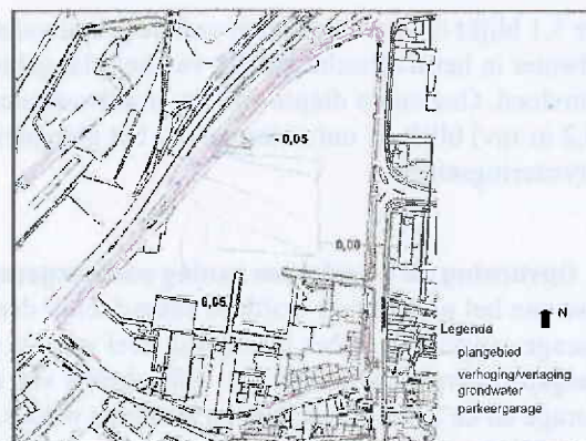
Figuur 5.3: Opstuwning grondwater a.g.v de aanleg van de 3-laags parkeergarage
