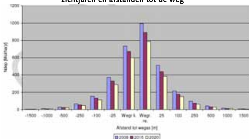
Afbeelding 5.5. 4 Stikstofdepositiebijdrage van het verkeer bij 100.000 mvt/ etmaal en 15% vracht voor de verschillende zichtjaren en afstanden tot de weg
